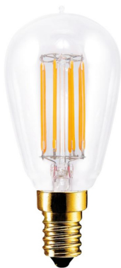
CM5563 Segula E14 LED filament EU 2200K 4,7W 400lm 220-240V
